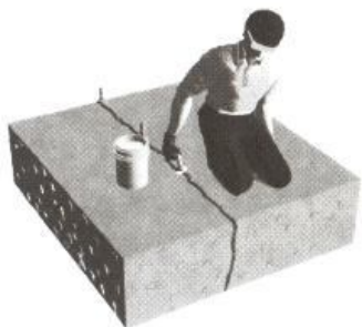
مرحله ۲- نصب شیرهای ورود مواد تزریق
